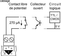
Le contact libre de potentiel a un courant de mouillage nominal de  $270~\mu A$ . L'entrée est sous tension lorsque le contact est fermé.
